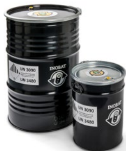
UN-geprüfte Stahlfässer 50 Liter und 212 Liter für Lithium-Batterien und Lithium-Ionen-Akkus mit Inliner und feuerhemmendem Füllmaterial Vermiculit.
