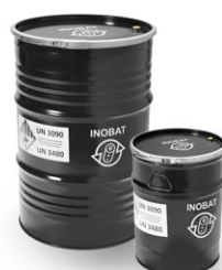
Fûts en acier de 50 et 212 litres certifiés ONU pour piles lithium-ion, avec revêtement et matériau de remplissage ignifuge vermiculite
