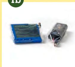
**Alternativ** oder ergänzend zum Abkleben können Li-Ionen-Akkus und Li-Batterien auch durch Verpacken in einem Plastiksack gegen Kurzschluss gesichert werden.
