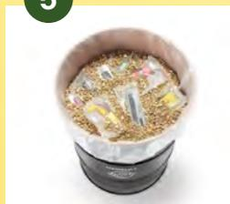
Auf jede Schicht Li-Ionen-Akkus und Li-Batterien wieder eine Schicht Vermiculit geben. Diesen Vorgang wiederholen, bis das Fass gefüllt ist.
