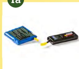
Die Pole der einzelnen Li-Ionen-Akkus und Li-Batterien durch Abkleben gegen Kurzschluss sichern.
