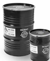
Fûts en acier de 50 et 212 litres certifiés ONU pour piles au lithium et accus lithium-ion, avec revêtement et matériau de remplissage ignifuge vermiculite
