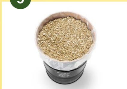
Nach der letzten Schicht Li-Ionen-Akkus und Li-Batterien nochmals alles mit Vermiculit bedecken.
