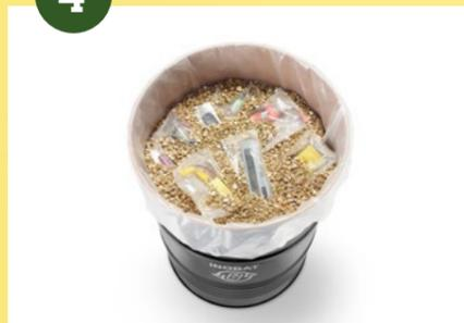
Auf jede Schicht Li-Ionen-Akkus und Li-Batterien wieder eine Schicht Vermiculit geben. Diesen Vorgang wiederholen, bis das Fass gefüllt ist.
