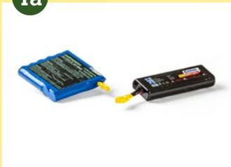
Die Pole der einzelnen Li-Ionen-Akkus und Li-Batterien durch Abkleben gegen Kurzschluss sichern.
