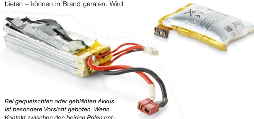
Bei gequetschten oder geblähten Akkus ist besondere Vorsicht geboten. Wenn Kontakt zwischen den beiden Polen entsteht, ist eine Selbstentzündung möglich.
