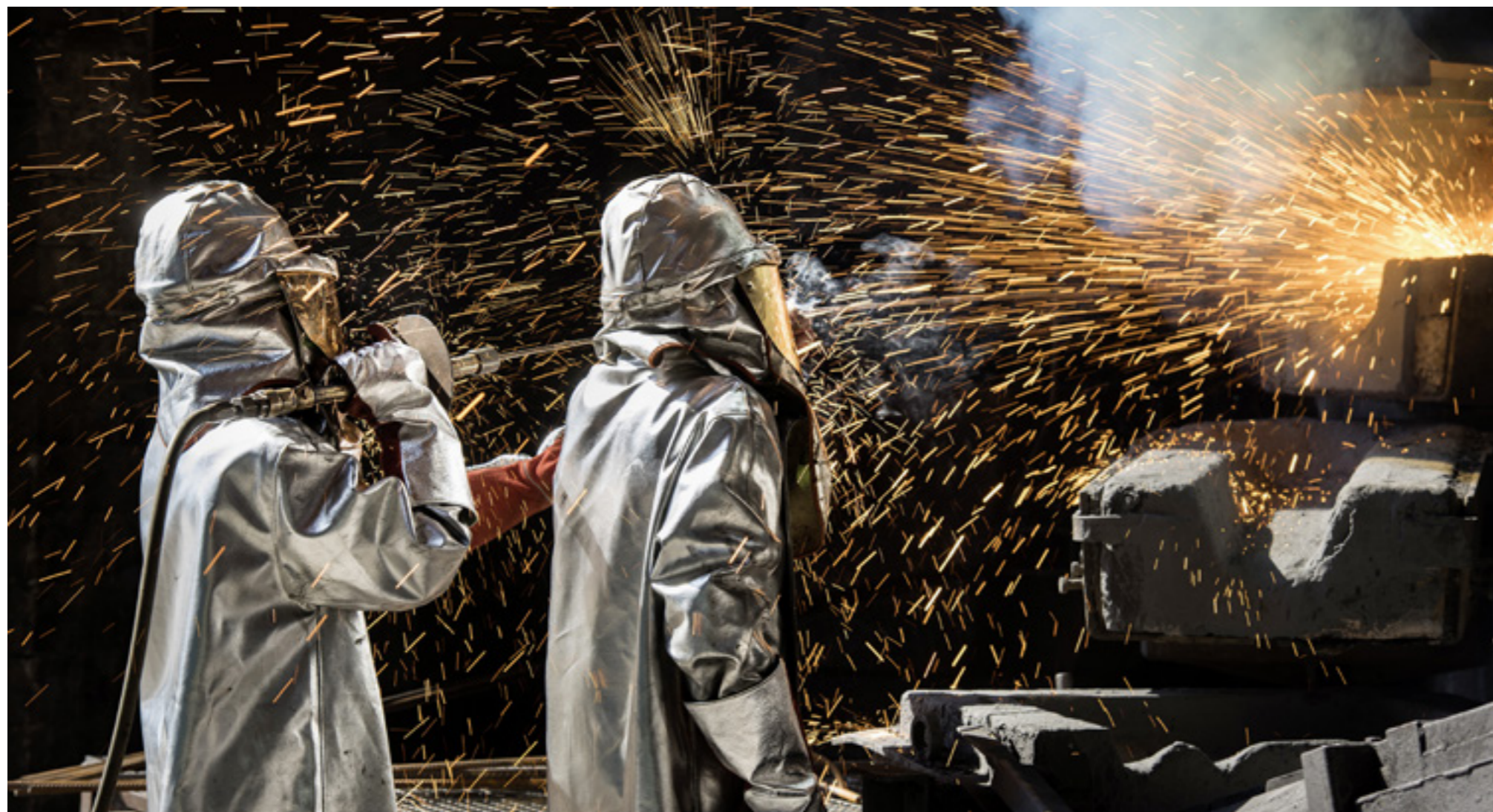
Le « piquage » de la masse en fusion avec des lances à oxygène, pour amorcer la coulée, est un travail physique. (Photo : David Schweizer)
