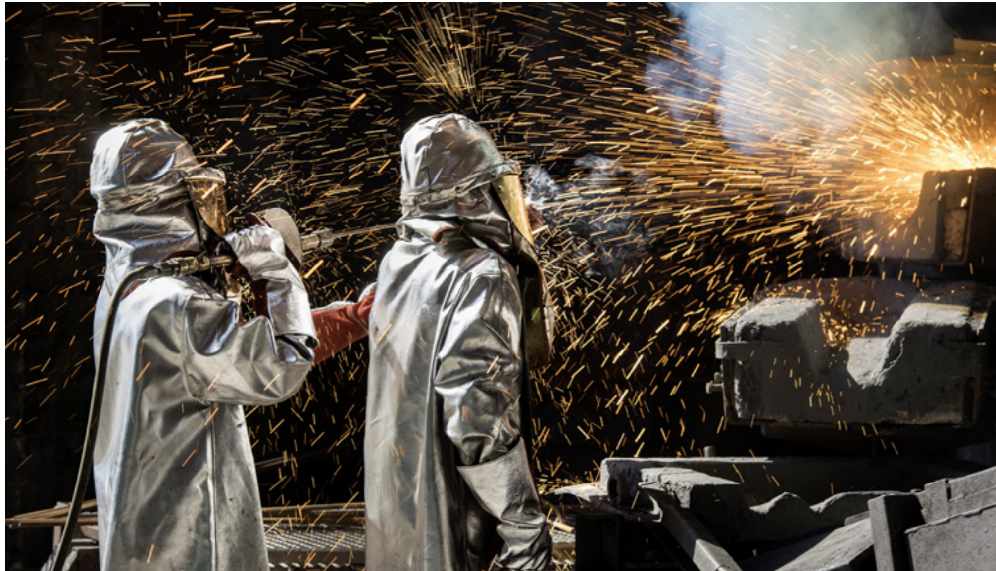
Das «Anstechen» der Ferromangan-Schmelze mit Sauerstofflanzen ist Knochenarbeit. (Bild: David Schweizer)
