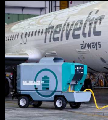
Alimentation électrique au sol
