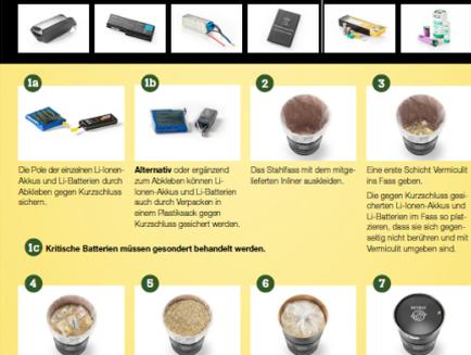
**1a** Die Pole der einzelnen Li-Ionen-Akkus und Li-Batterien durch Abkleben gegen Kurzschluss sichern.
