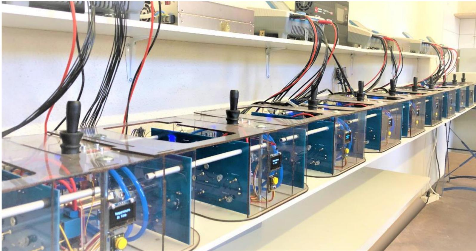
Testsystem für Zellenmodule
