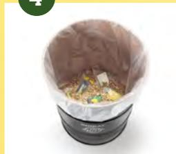
Une première couche de vermiculite est mise en place dans le fût.
