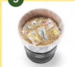
Une couche de vermiculite est versée sur chaque couche d'accus Li-ion et de piles Li.
