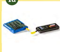
Les bornes de chaque accus Li-ion et de chaque pile Li doivent être isolées au moyen d'un ruban adhésif, afin d'éviter des courts-circuits.
